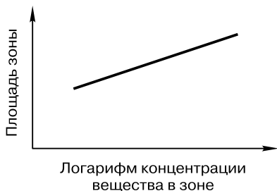
Рис. 36. Соотношение между площадью зоны и концентрацией исследуемого вещества в зоне хроматограммы
